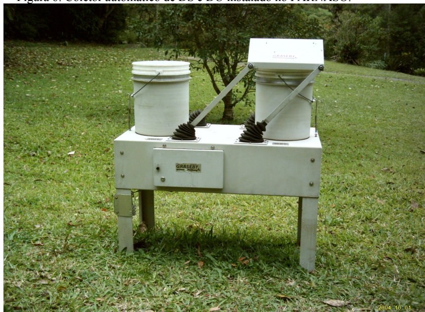
Figura 6: Coletor automático de DS e DU instalado no PARNASO.
