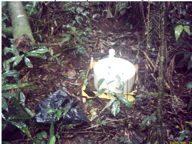
Figura 7: Câmara estática para medição de fluxo de N_2O , na trilha Mozart Catão.
